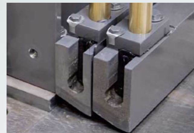
Profondeur de trempage homogène de 5 mm dans les dameurs et les lames de pression.
