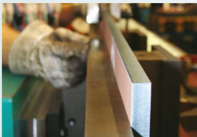
Le dressage sans contrainte et une tolérance de planéité maximum de 2/10 mm assurent une longue durée de vie à la tôle lisseuse, grâce à une usure régulière.
