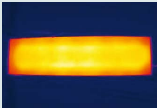
Image par rayonnement thermique d'une tôle lisseuse. La puissance de chauffe constante et homogène sur toute la surface est une condition importante pour une bonne qualité de pose.
