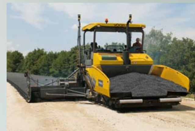
Les tables de pose VÖGELE munies de sabots de profilage réalisent des valeurs de compactage élevées homogènes et des bords parfaits en une seule passe.
