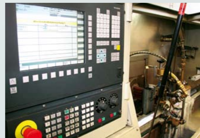
La trempage par induction des dameurs et des lames de pression assure une grande longévité.
