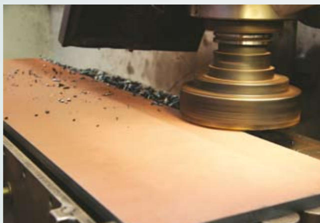
Fraisage précis de la tôle lisseuse et du bord avant.
