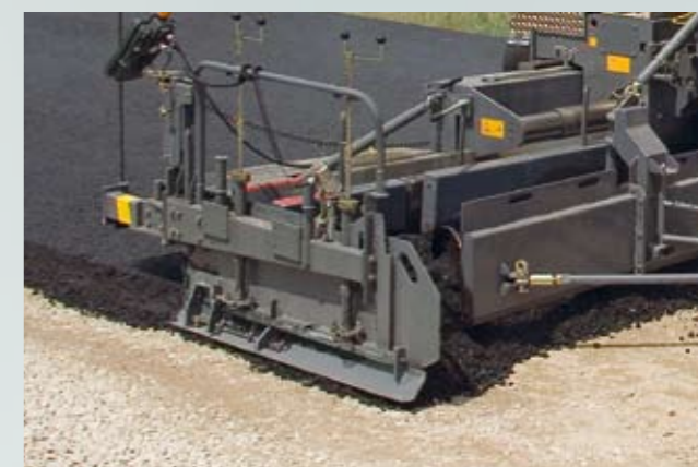
Les sabots de profilage à chauffe électrique garantissent une surface lisse.
