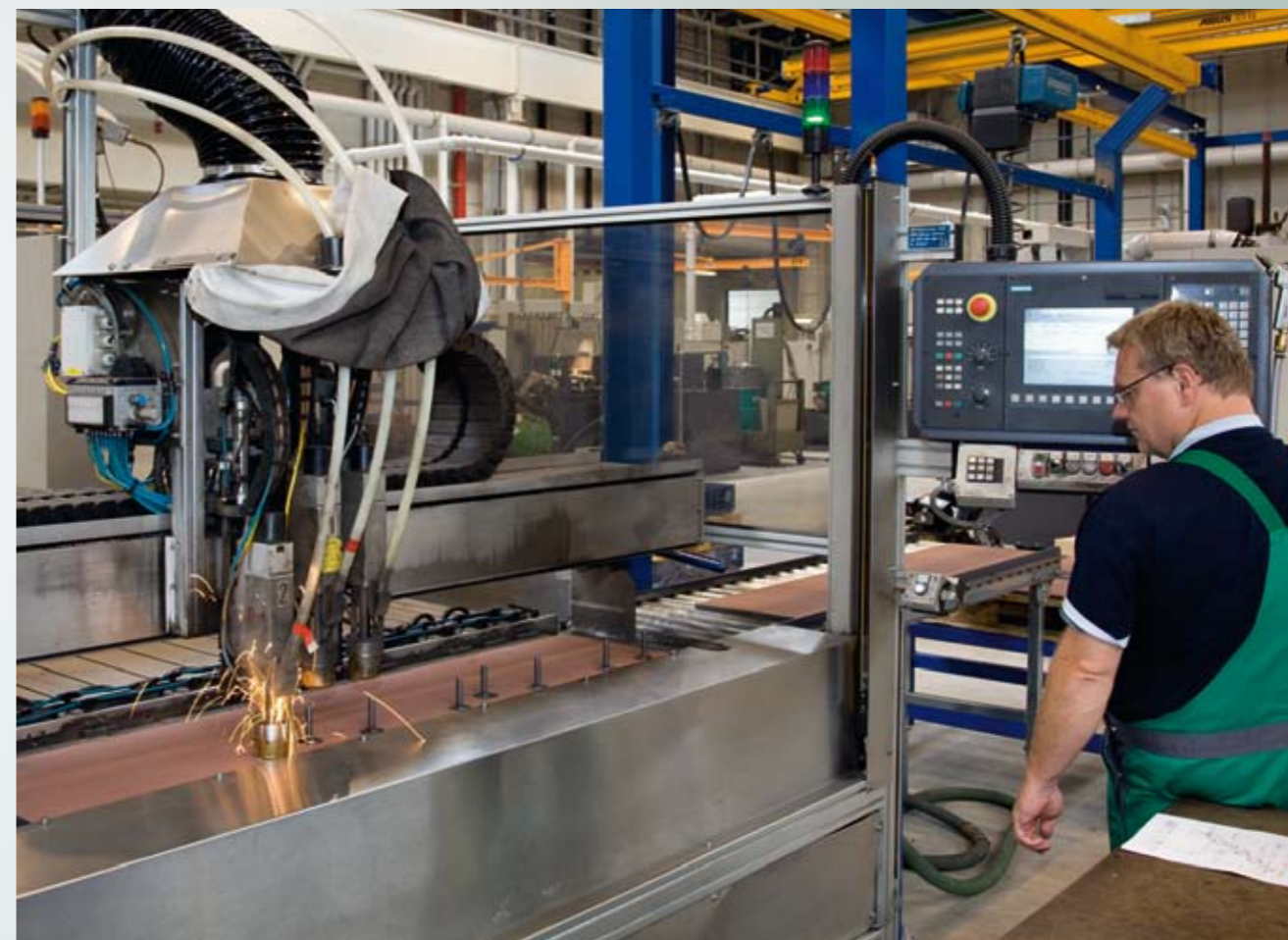
Soudure des goujons par commande CNC.
